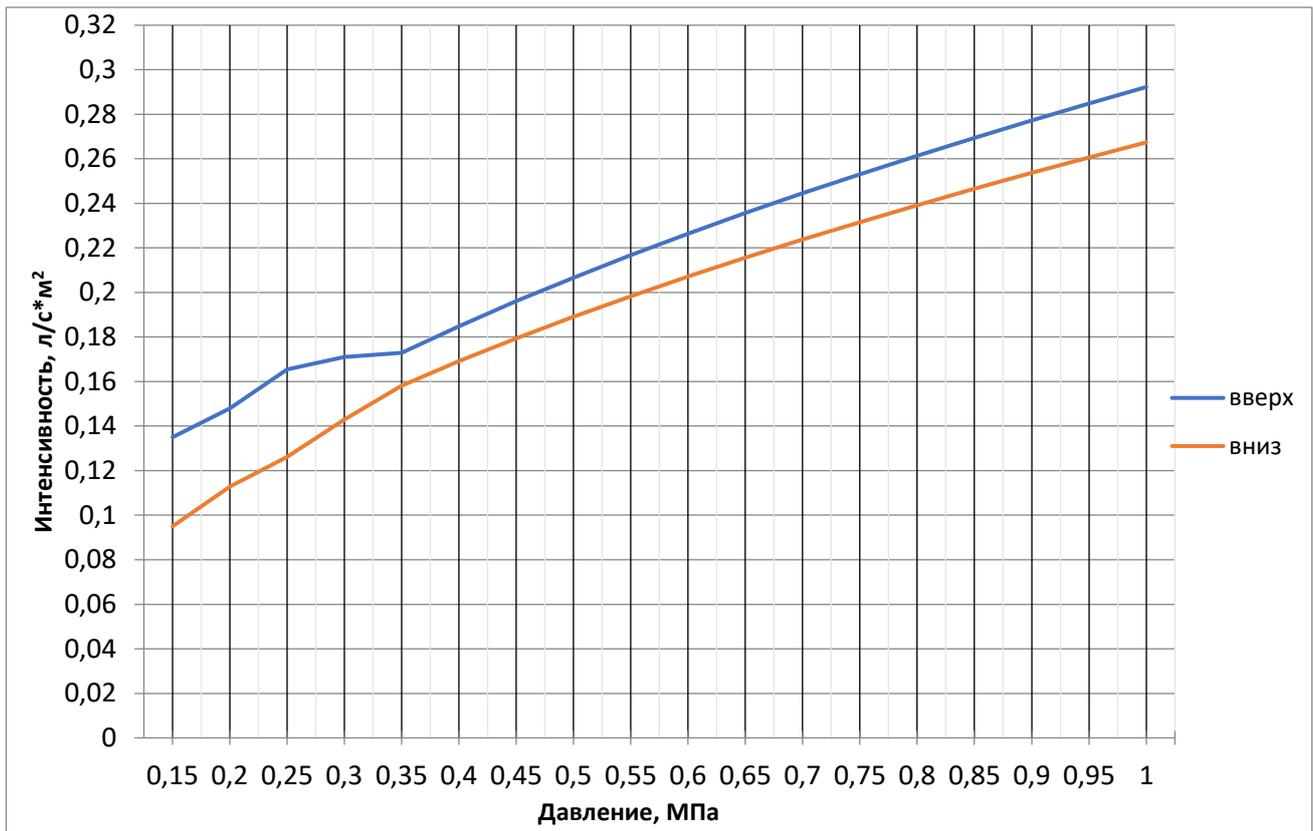
**График зависимости интенсивности орошения от давления на площади 12 м<sup>2</sup>, защищаемой группой оросителей (два и более) с высоты 2,5 м**
